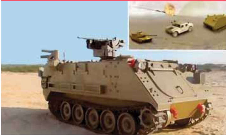
Оклопно возило M113 APC са системом Iron Fist и његово дејство (лево горе). Бласт ефекат система (десно)
